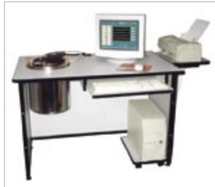
2.4 pav. Kalorimetrinės bombos įranga pagal LST EN ISO 1716:2004
