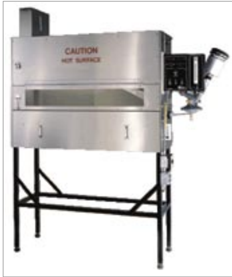
2.8 pav. Grindų dangų degumo badymo įranga LST EN ISO 9239-1:2004
