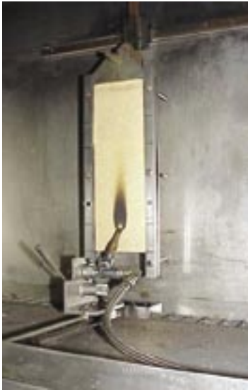
2.7 pav. Užsidegamumo bandymas pagal LST EN ISO 11925-2:2003
