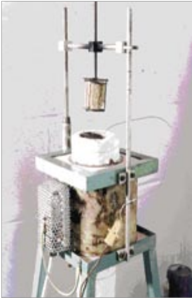
2.3 pav. Nedegumo bandymo įranga pagal LST EN ISO 1182:2002
