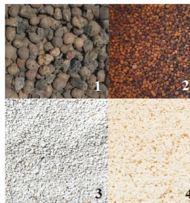
2 paveikslas. Filtrų kolonų užpildai: 1 – užpildų palaikantysis sluoksnis (akmenėliai); 2 – OG užpildas; 3 – ceolito užpildas; 4 – Purolite užpildas
