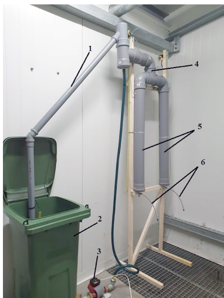
1 paveikslas. Filtravimo eksperimentinis stendas: 1 – persipylimo vamzdis, 2 – valytų nuotekų talpa, 3 – valytų nuotekų tiekimo siurblys, 4 – nuotekų paskirstymo į kolonas vamzdis, 5 – filtravimo kolonos, 6 – filtruotų nuotekų išleidimo vieta
