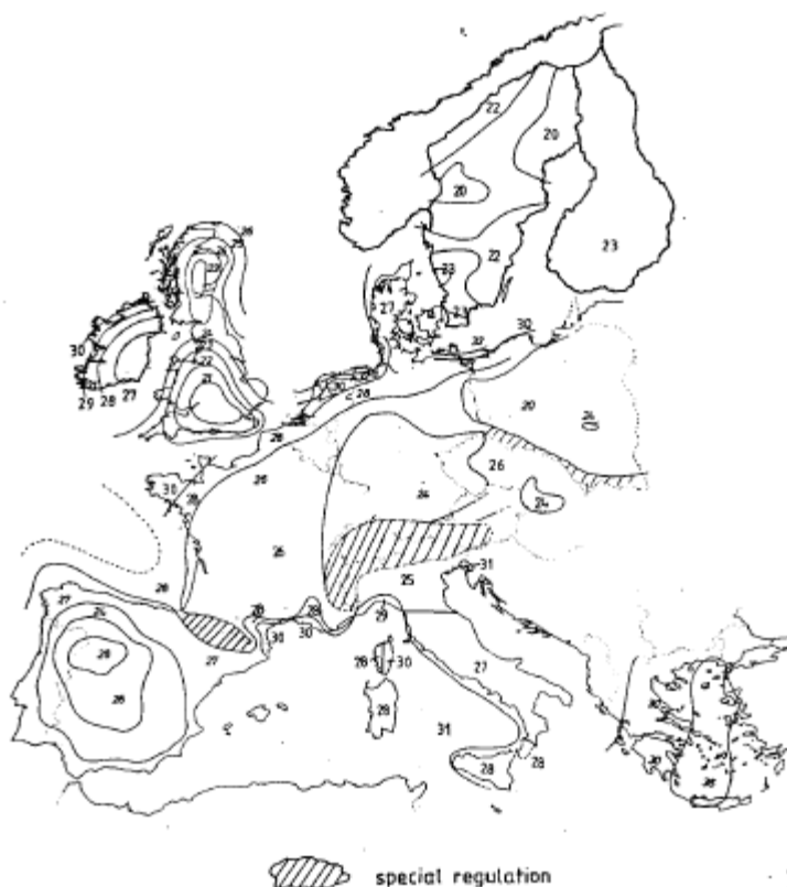
28 pav. Europos vėjo svarbiausių pagrindinio vėjo greičio v_{b,0} reikšmių žemėlapis (tik nurodantys dydžiai)
