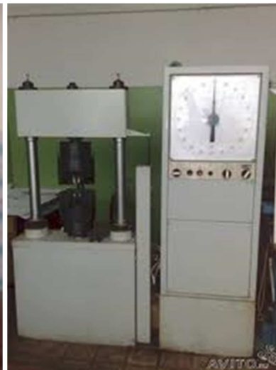
9 pav. Senos kartos blokinės tempimo mašinos su torsioniniu jėgos matuokliu hidrauline pavara pavyzdys (MP-200)
