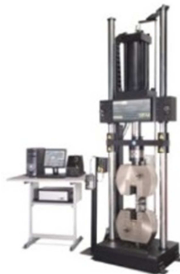
15 pav. Šiuolaikinės universalios bandymų mašinos su hidrauline pavara ir kompiuteriniu valdymu pavyzdys (Instron KN)
