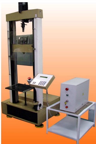
30 pav. Universalios mašinos su elektrine pavara modernizuotas variantas: valdymo pultas ir jėgos blokas
