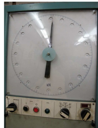
21 pav. Senos kartos tempimo mašinos bandymo su torsioniniu jėgos matuokliu bandymo rezultatų registravimo įtaisai: būgninis diagramos braižytuvas, jėgos skalė (MP-200)
