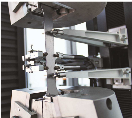
17 pav. Šiuolaikinių pusiau automatinių skersinių deformacijų matavimo ekstensiometrų pavyzdys (EAN)
