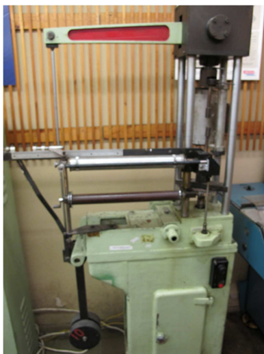
7 pav. Senos kartos monoblokinės tempimo mašinos su svirtiniu-švytuokliniu jėgos matuokliu ir mechanine pavara pavyzdys
