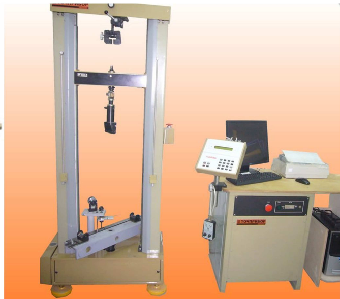
29 pav. Universalios mašinos su elektrine pavara modernizuotas variantas: jėgos blokas, valdymo pultas, kompiuteris
