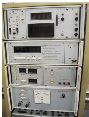
22 pav. Senos kartos universalios tempimo mašinos su tenzo jėgos matuokliu bandymo rezultatų registravimo įtaisai: ploteris, jėgos ir traversos eigos elektroniniai indikatoriai, parametrų valdymo blokai (2067)
