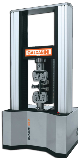
14 pav. Šiuolaikinės grindinės universalios bandymų mašinos su elektromechanine pavara ir kompiuteriniu valdymu pavyzdys (Quasar 250)
