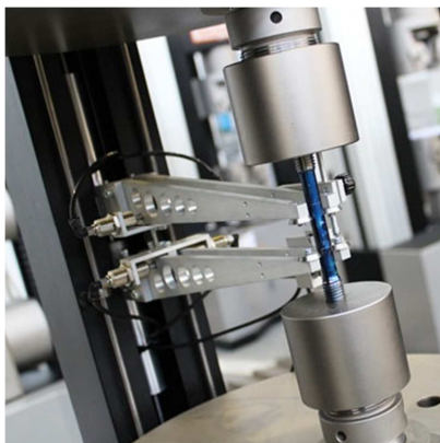
16 pav. Šiuolaikinių pusiau automatinių išilginių deformacijų matavimo ekstensiometrų pavyzdys (Micron)
