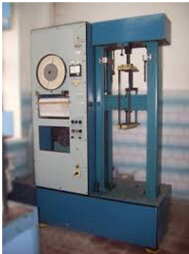
8 pav. Senos kartos monoblokinės universalios mašinos su švytuokliniu jėgos matuokliu ir mechaninė pavara pavyzdys (P-5)
