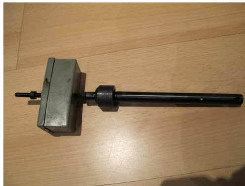
23 pav. Senos kartos tempimo mašinos bandymo tenzojutiklio pavyzdys (2054)
