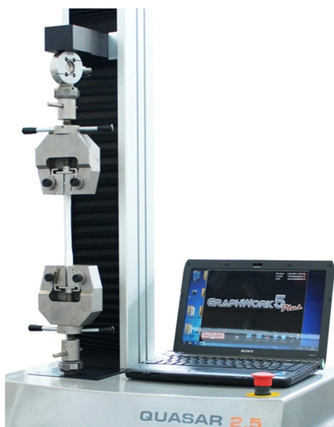
13 pav. Šiuolaikinės stalinės universalios bandymų mašinos su elektromechanine pavara ir kompiuteriniu valdymu pavyzdys (Quasar 2.5)
