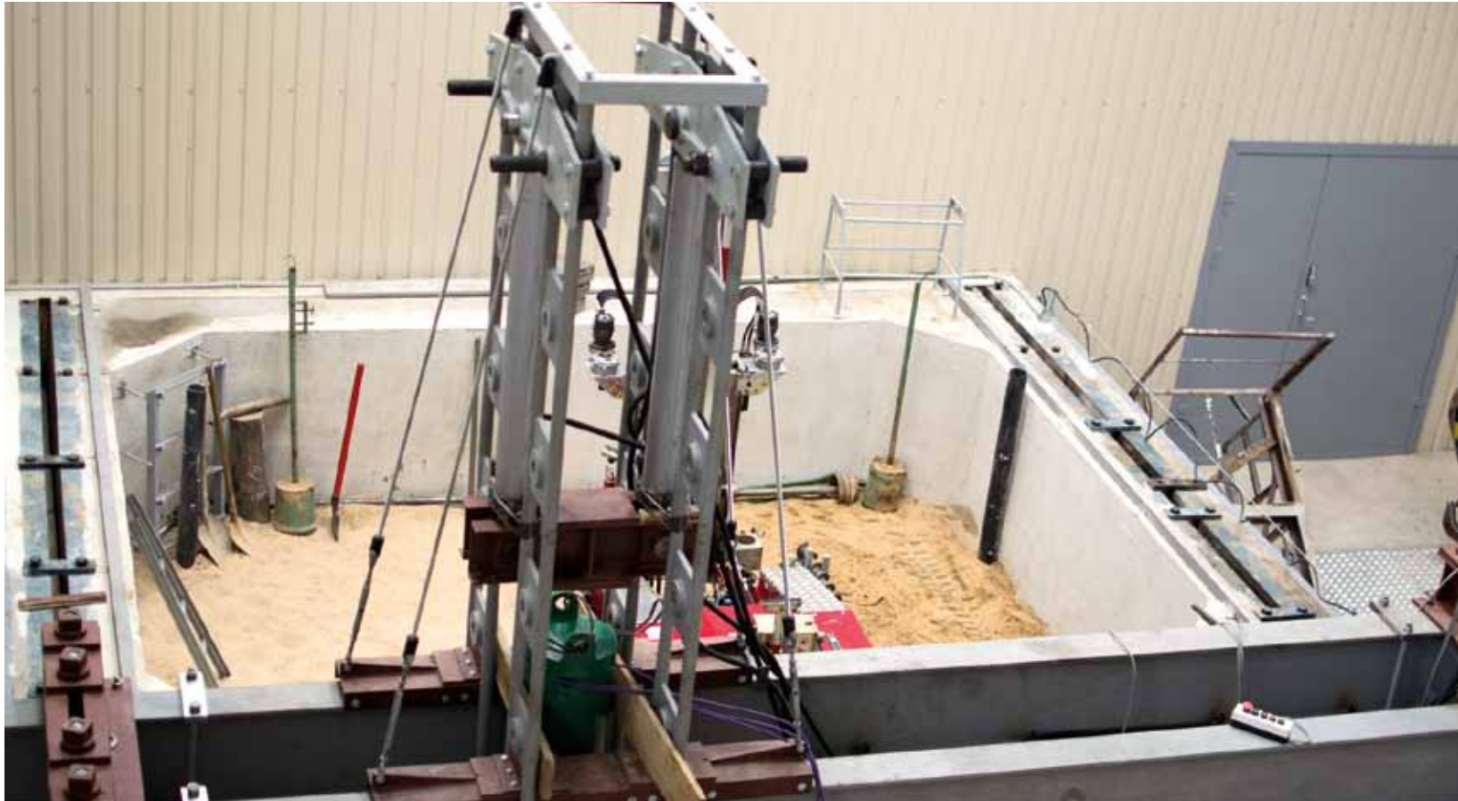
Pamatų bandymo stendas. Studentai pamatų bandymo stendą mieliau vadina „smėlio dėže“. Tačiau visiems aišku, kad čia galima atkurti gamtines grunto slūgsojimo sąlygas, tokias kaip grunto sluoksniuotumas, grunto vandens lygis ir pan., bei laboratorinėmis sąlygomis išbandyti bet kokio tipo pamatus. Ši informacija leidžia ne tik plėtoti supratimą apie gruntų mechaniką, vizualiai parodyti studentams, kas vyksta apkraunant pamatus, bet ir pateikti rekomendacijas pamatų skaičiavimo metodikos tobulinimui
