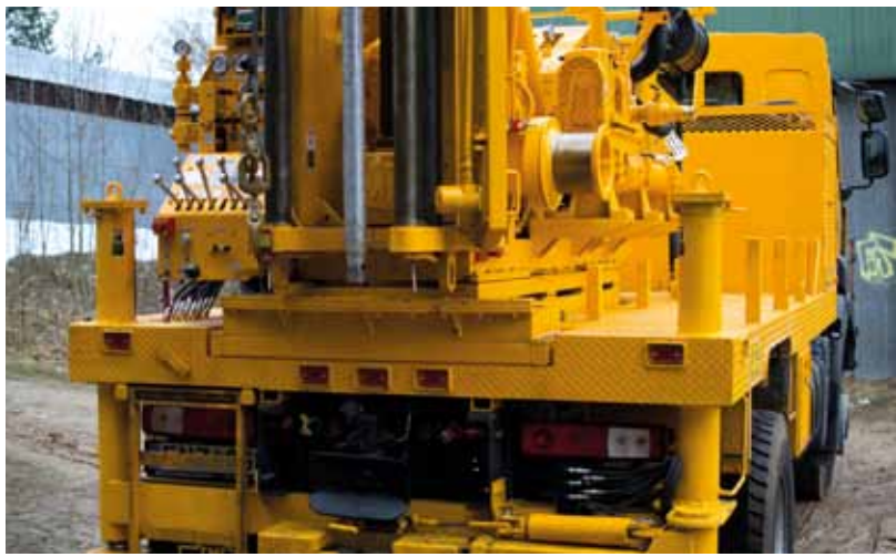
Gręžimo agregatas. Šiuo prietaisu galima ne tik išgręžti gruntą iki 30 m gylio, bet ir paimti mėginius, kuriuos vėliau galima tirti laboratorinėmis sąlygomis, t. y. nustatyti grunto fizines ir mechanines savybes
