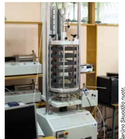
Triašio slėgio aparatas. Šis prietaisas yra vienintelis Lietuvoje. Jis unikalus, nes gali apkrauti bandinį dinaminiame apkravoje. Dėl šios papildomos funkcijos galima tirti, pvz., transporto sukeltus dinaminis poveikius pastatų nuosėdžiams ir konstrukcijų pleišėjimui
