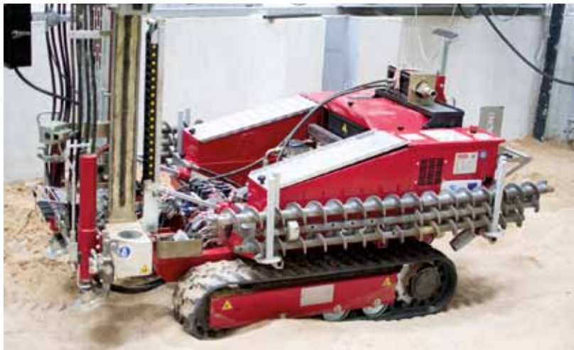
Grunto zondavimo aparatas. Šis savaeigis prietaisas dėl didelio pravažumo ir mažų matmenų gali nuvažiuoti į visas statybos aikštelės vietas. Šiuo zondavimo aparatu yra gaunami duomenys, kurie vėliau panaudojami pamatų projektavime ir / arba grunto savybių aprašymui. Zondavimo gylis gali būti įvairus, tai priklauso nuo tiriamo grunto stiprumo. Jei gruntas yra silpnas, tai galima gauti apie 40 m zondavimo rezultatus, jei stiprus – tik apie 8 m
