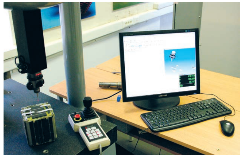
Palydovo geometrinių parametrų matavimas koordinatų matavimo mašina
