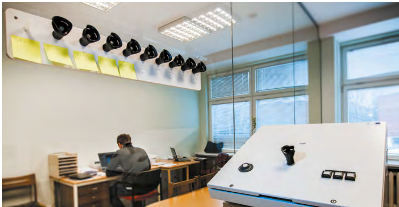
Kvapų tyrimų laboratorija. Nuotraukos kairėje – tyrimuose dalyvaujančių uostytojų „nosytės“. 5 tyrėjai paeiliui prie olfaktometro (nuotraukos centre) uosto švairiu oru praskiestus mėginius. Pirmieji mėginiai būna praskiesti tūkstančius kartų
