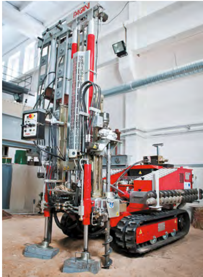
Lauko eksperimentinių tyrimų laboratorija. Gruntų zondavimo įranga, galinti tirti gruntuos 20–30 metrų gilyje. Po zondavimo įranga sumontuotas pamatų bandymo stendas, kuriuo galima vertikaliai ir horizontaliai bandyti įvairiausių rūšių pamatus, „sukurti“ natūralų grunto vandens lygį. Tai – unikalus ir vienintelis stendas Baltijos šalyse, panašų, tik mažesnį, stendą turi Miuncheno technikos universitetas
