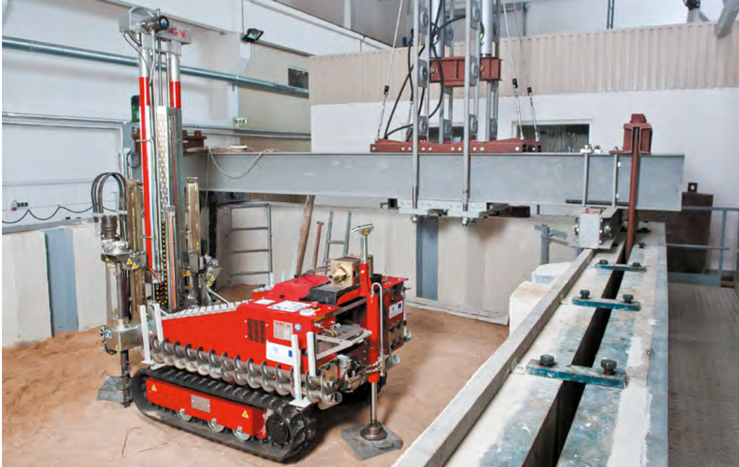
Lauko eksperimentinių tyrimų laboratorija. Gruntų zondavimo įranga, galinti tirti gruntuos 20–30 metrų gilyje. Po zondavimo įranga sumontuotas pamatų bandymo stendas, kuriuo galima vertikaliai ir horizontaliai bandyti įvairiausių rūšių pamatus, „sukurti“ natūralų grunto vandens lygį. Tai – unikalus ir vienintelis stendas Baltijos šalyse, panašų, tik mažesnį, stendą turi Miuncheno technikos universitetas
