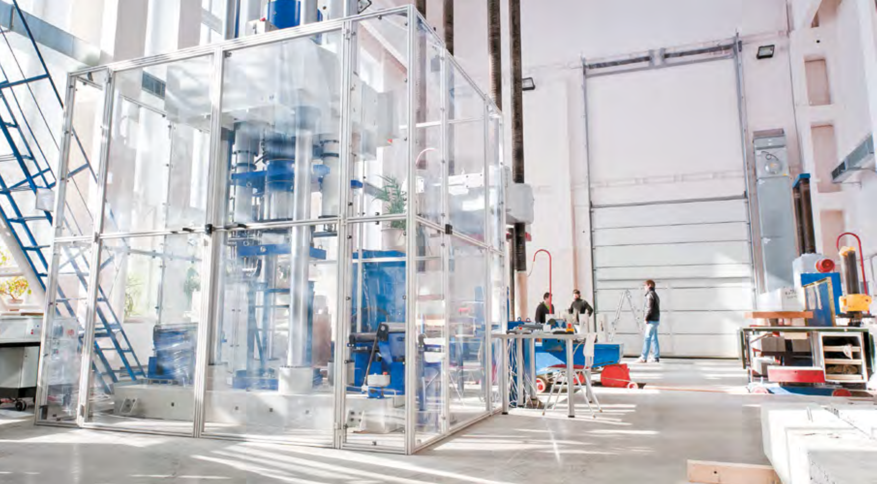
Servohidraulinė universali bandymo mašina LRV 5000 (5000 kN galios). Įranga padeda imituoti realias statinių konstrukcijų apkrovas
