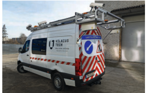
VILNIUS TECH Kelių tyrimo instituto mobiliąja laboratorija su lazerine plyšių matavimo sistema
